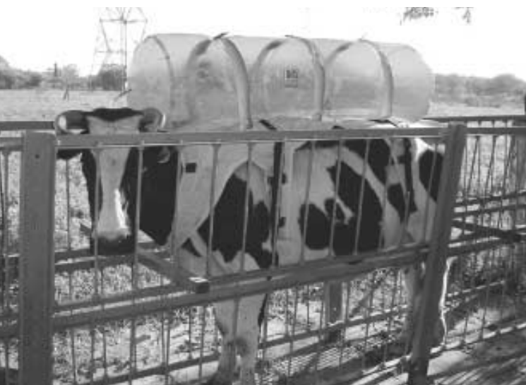
Vaca mochilera. El sistema colocado en el lomo del animal sirve para medir las emisiones de metano que produce un animal. Foto: Gentileza INTA
